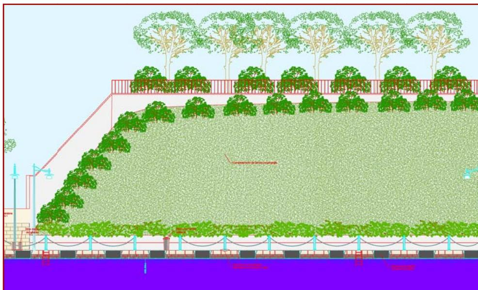
Figura 9.8: Prospetto di progetto area da consolidare con sistema delle terre armate
